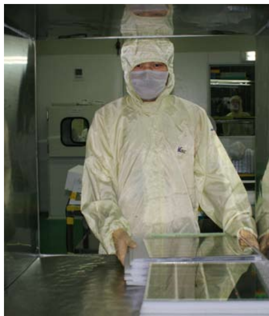
Intagning av LCD displayer i back-end produktionen i Kina via en materialsluss.
